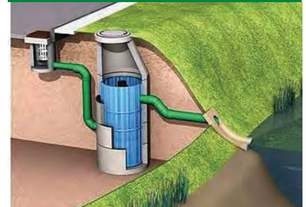
SISTEMAS DE APROVEITAMENTO DE ÁGUAS PLUVIAIS PARA REGA
